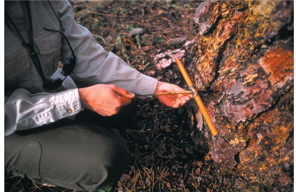
Extracción con barrena de Pressler de una pequeña muestra de madera para ver los anillos
